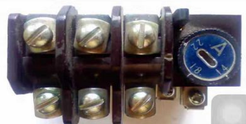
10kW电动机20A，热元件的额定电流选择22A 整定值就是电动机的额定电流值20A
