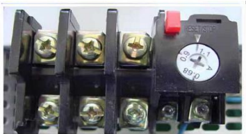
热元件的额定电流为电动机额定电流的1.1-1.25倍。 整定值为1倍（图中整定值为1.05A）
