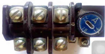
10kW电动机20A, 热元件的额定电流选择22A 整定值就是电动机的额定电流值20A
