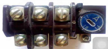
10kW电动机20A，热元件的额定电流选择22A 整定值就是电动机的额定电流值20A
