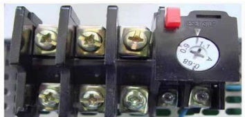
热元件的额定电流为电动机额定电流的1.1-1.25倍， 整定值为1倍（图中整定值为1.05A）
