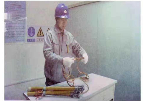
检修安全用具：临时接地线
